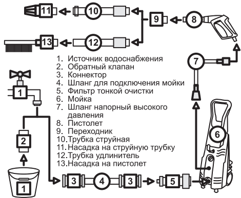
Рис. 13 Схема подключения аппарата с дополнительным оборудованием
