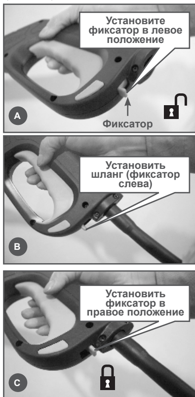
Рис. 3 Подключение шланга высокого давления к пистолету
